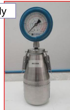
la pressione che si sviluppa quando il terreno umido va a contatto con il carburo di calcio è correlabile al contenuto d'acqua
