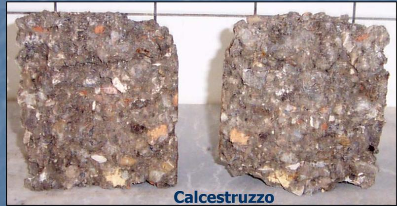
Sezione di due provini di misto cementato
