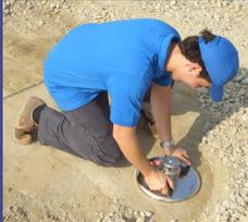
Misura il Modulo di Deformazione dinamico E<sub>vd</sub> (MPa). Una massa battente da 10 o 15 kg cade su una piastra di acciaio circolare di diametro 30 cm. Un accelerometro misura l'abbassamento della piastra.
