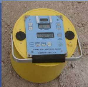
Misura la rigidità dello strato addensato. Un anello metallico eccita il terreno con una forza dinamica alla frequenza di circa 100 Hz. Due sensori di velocità misurano lo spostamento locale del terreno e ne restituiscono la rigidità.
