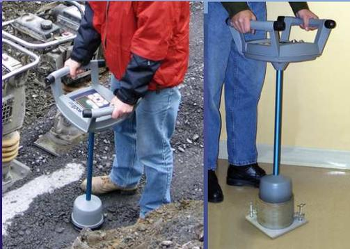
Misura il Modulo di Ricarico di un terreno. L'idea è di sfruttare la flessione di una piastra 2x150 mm sul suolo. Spingendo a terra il sensore si inflette la piastra in misura maggiore o minore a seconda della rigidità del piano. L'operatore deve appoggiarsi al manubrio e generare una forza di almeno 223 N (circa 20 kg).
