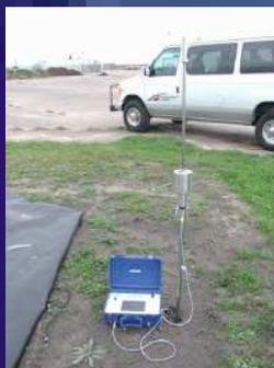
Misura l'umidità del terreno in sito sulla base della costante dielettrica. Due elettrodi ad anello misurano l'umidità nell'intorno del dispositivo calcolando la variazione di frequenza del terreno rispetto al segnale di eccitazione.
