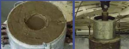
Si può realizzare anche entro fustelle CBR e la correlazione con la prova CBR statica in laboratorio è eccellente.
