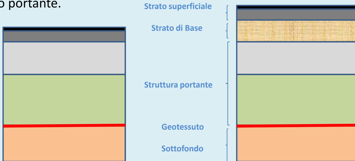
Lo strato di base ha il compito di resistere ai carichi verticali trasmessi localmente dagli strati superficiali a diretto contatto con il traffico, ripartendoli sulla sottostante fondazione di minore qualità portante . Deve possedere una elevata resistenza meccanica, un'elevatissima resistenza a fatica e una sufficiente flessibilità, per poter seguire , sotto gli stessi carichi, l'eventuale assestamento del sottofondo.
