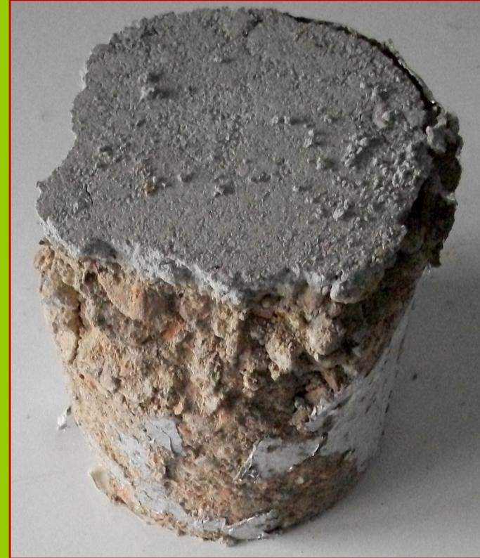
Provini del mix 75% aggregato di riciclo 0-70 mm + 25% scoria di fonderia sottoposti a compressione
