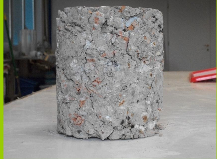
Provini del mix aggregato di riciclo 0-30 mm + 2% cemento
