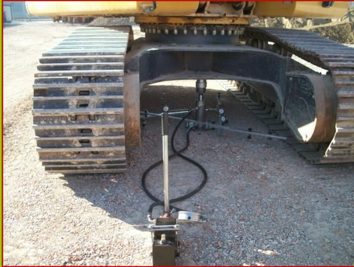
Prova di carico su piastra su aggregato di riciclo 0-30 mm
