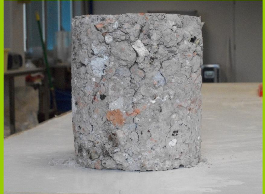
Provini del mix 85% aggregato di riciclo 0-30 mm + 15% scoria di fonderia sottoposti a compressione
